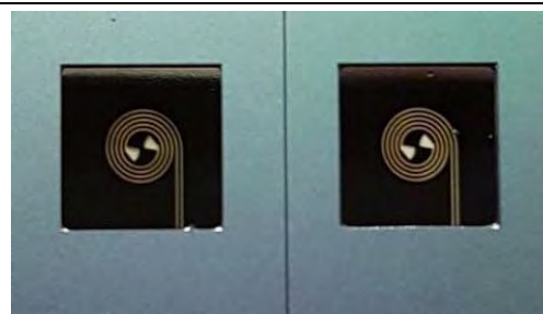
Antene metalice spiralate obținute pe membrane dielectrice subțiri
