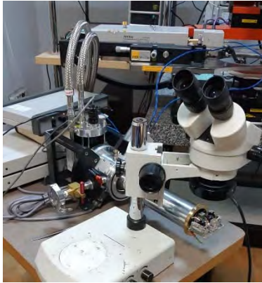
Set-up pentru masuratori criogenice (pana la 4 K) ale parametrilor S pana la 110GHz
