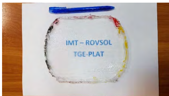
Imaginea fotografică a componentelor optice realizate. Stânga: imaginea componentei optice de PDMS pusă peste un text (pixul și foaia A4 pe care este scris textul sunt prezentate pentru a permite comparația dimensională); Dreapta: imaginea textului de referință, fără nici o lentilă deasupra sa.
