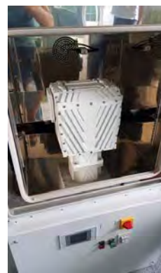
Fig. 7c - Camera climatica pentru testari de mediu (temperatura: -40°C/+180°C; umiditate: 10-95% RH)
