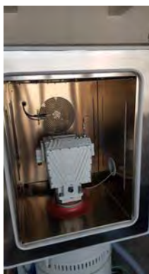
Fig. 7b - Sistem de vibratii cu camera climatica (Banda de frecventa : 2000Hz. Masa maxima a dispozitivului testat 50kg)
