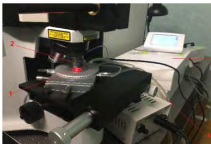
Platforma de testare cuplata la spectrometrul micro-Raman, LabRAM HR 800. 1- celula termo-electrica cu acces optic; 2- obiectivul microscopului confocal, cu distanta focala de 4,5 mm; 3- controllerul pentru temperatura; 4 - legatura catre pompa de recircularea apei.
