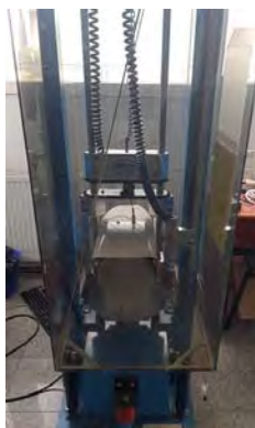
Fig. 7a - MRAD 0707-20 - Free Fall Sock Machine / Cambridge cu Thermal Camera - CONDOR VLRD 660 instalata pentru testare;
